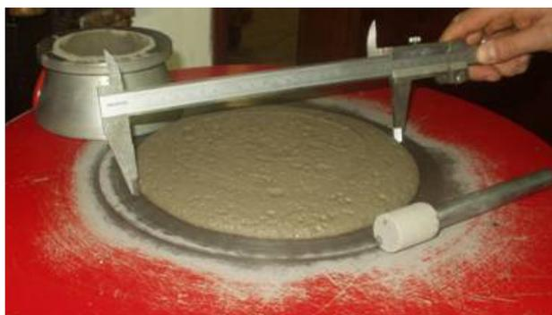
Figura 3 - Medida de consistência de argamassa em mesa cadente.
