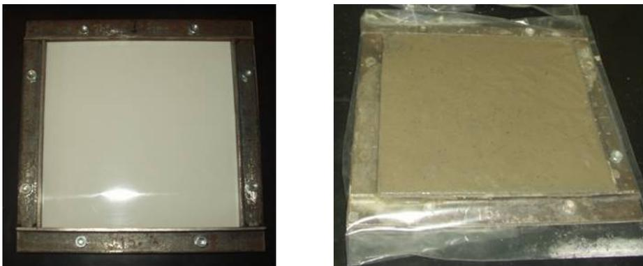
Figura 9 - Fôrma, moldagem e cura dos ladrilhos hidráulico.
