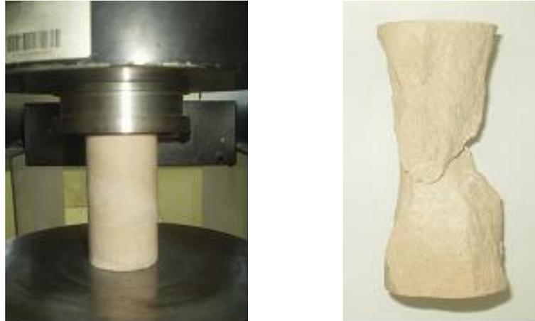
Figura 5 - Corpo-de-prova solicitado à compressão axial simples com ruptura cônica.
