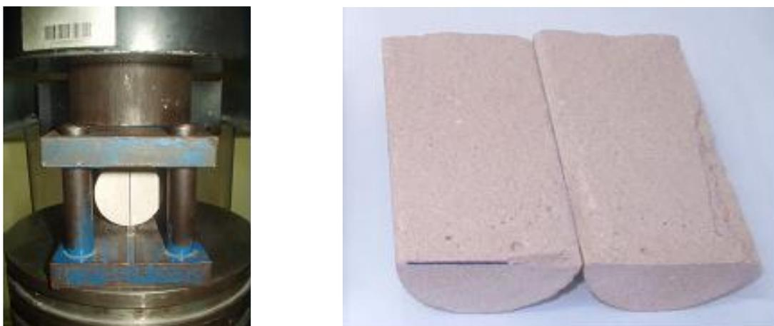
Figura 6 - Corpo-de-prova solicitado à compressão diametral com ruptura colunar.
