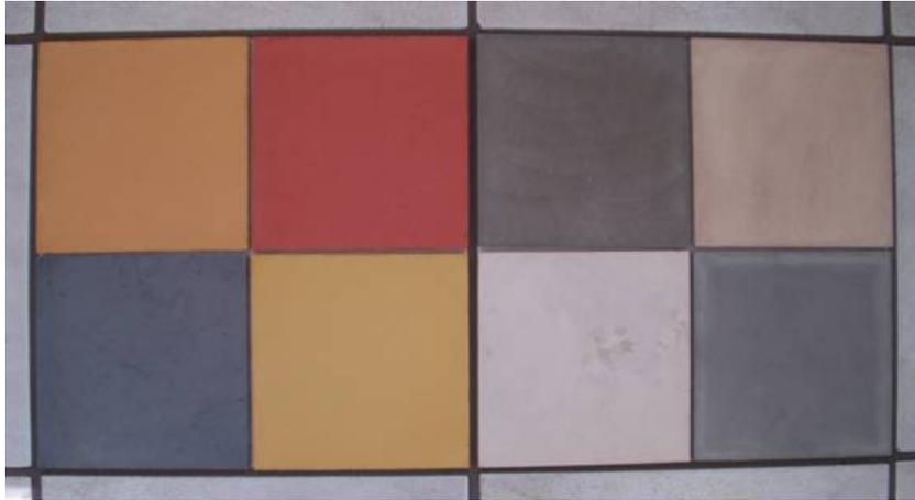
Figura 13 - Diversidade de ladrilhos hidráulicos moldados com e sem pigmento.
