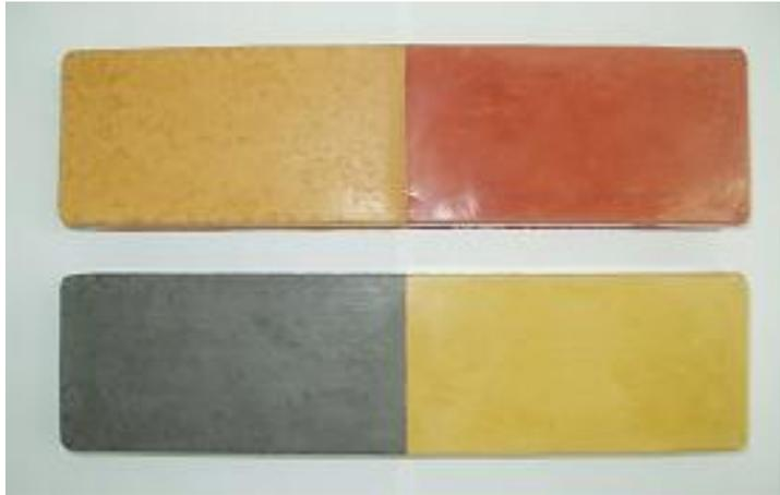
Figura 14 - Elementos hidráulicos após junção de argamassas em diferentes idades.
