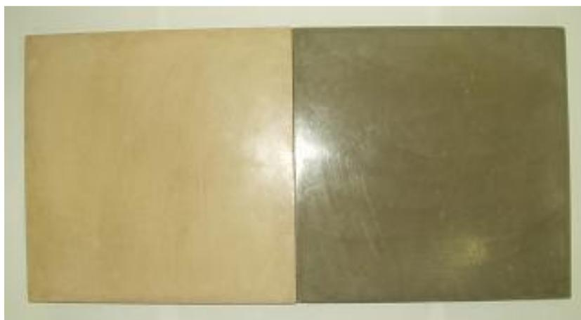
Figura 15 - Ladrilhos hidráulicos após restauração de superfície.
