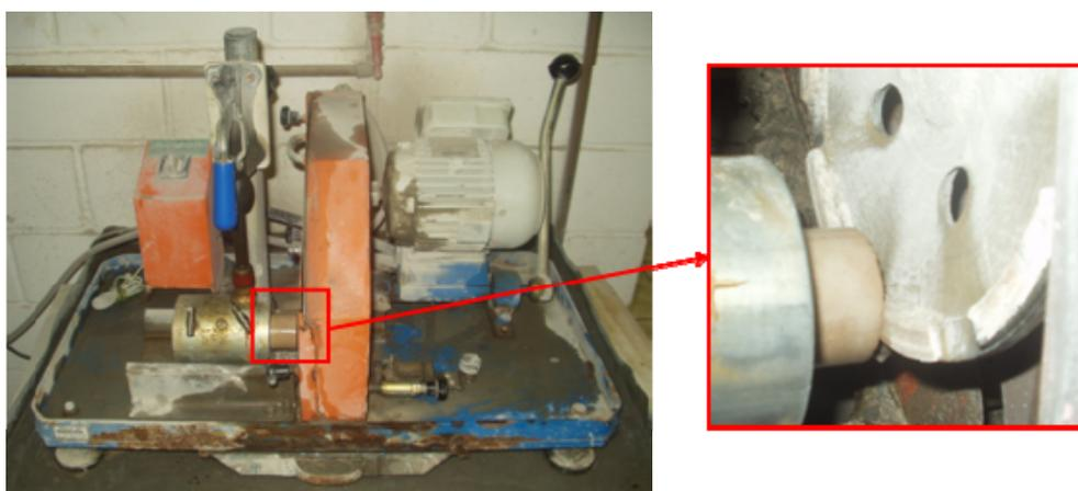
Figura 4 - Faceador para corpos-de-prova com detalhe do disco.
