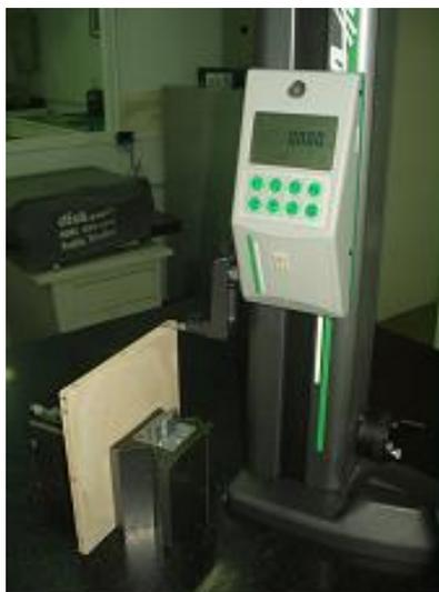
Figura 12 - Medida de ladrilhos hidráulicos em torre eletrônica de medição.
