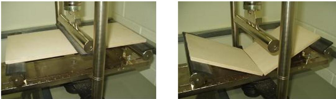
Figura 10 - Ladrilho hidráulico solicitado à flexão com ruptura no terço central.
