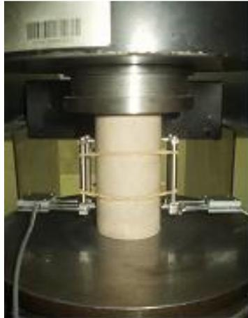
Figura 7 - Ensaio para determinação do módulo de elasticidade.
